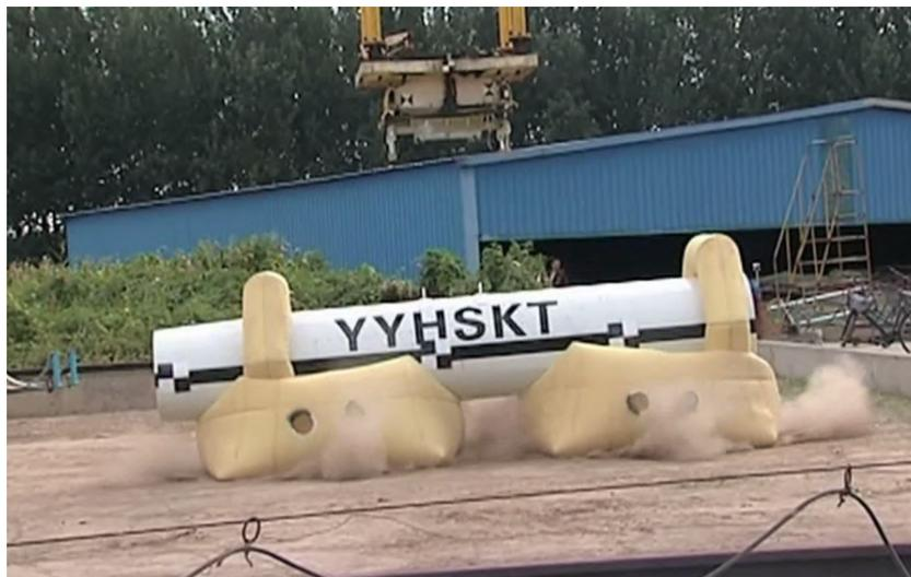
图6 运载火箭一子级缩比模型气囊着陆冲击试验
