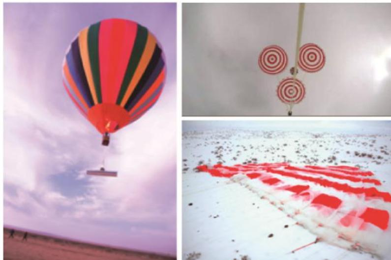
图 5 运载火箭一子级缩比模型群伞系统空投试验
