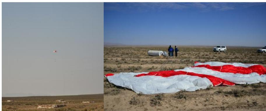
图7 冲压翼伞可控回收运载火箭助推器缩比样机演示试验
